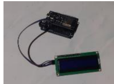
Gambar 4. Rangkaian LCD dan ESP32
